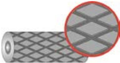
El caucho SH-A MIDI-RED es más resistente al desgaste que el caucho SH-A MINI 60. El caucho de revestimiento perfilado para tambores está destinado a mejorar el coeficiente de rozamiento entre el tambor motriz y la cinta transportadora. Impide el gripado, favorece al movimiento recto de la cinta transportadora, desplaza el agua y barro de ranuras del perfil. Protege el tambor del desgaste y corrosión.
